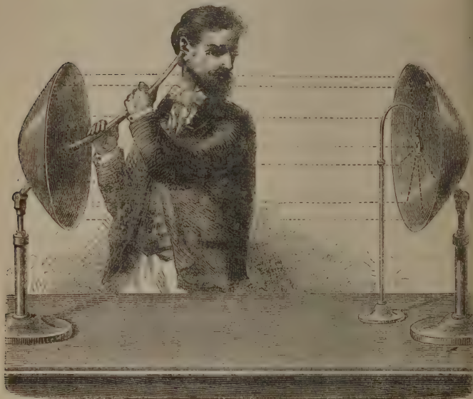
Fig. 9. — Vérification expérimentale des lois de la réflexion du son.
